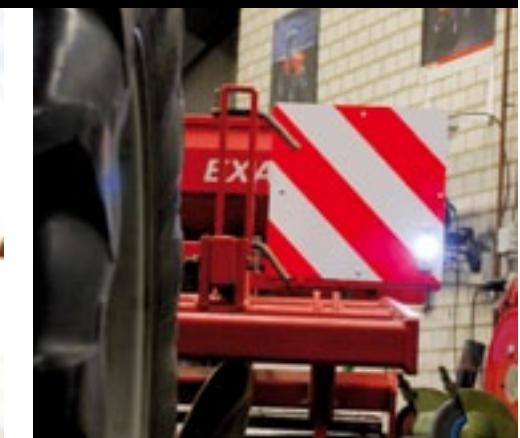
▲ De breedtemarkeringsplaten in combinatie met de breedtelichten geven de maximale breedte van de machine goed aan.
