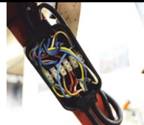
▲ Maak de kabels op maat; vooral bij de massa en de verlichting komen veel kabels bij elkaar. Met kortere kabels houd je meer ruimte in de doos.
