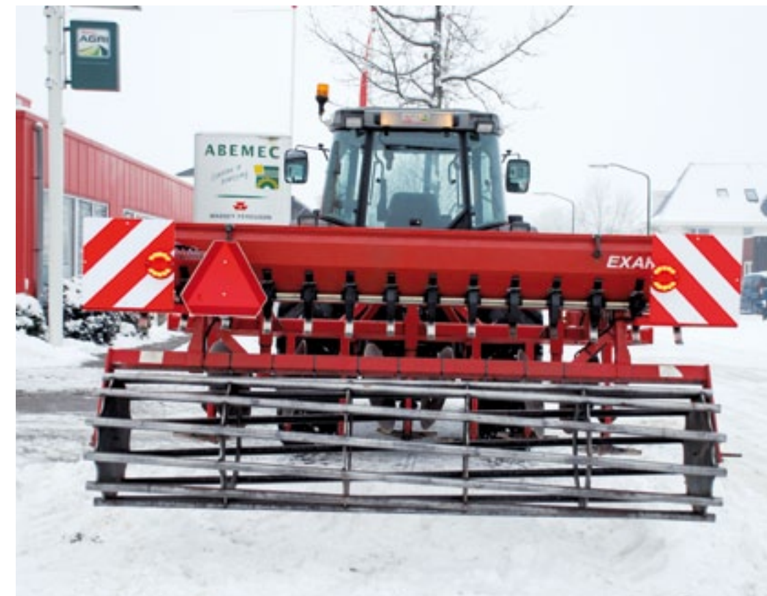
▲ De heldere led-verlichting is ongeveer twee keer zo duur als gewone vaste verlichting op een machine, maar gaat langer mee. Het is beter bestand tegen trillingen en vocht.
