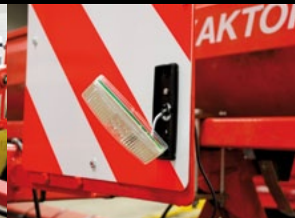
▲ Zorg er bij zware verlichting voor dat je ook door de metalen steun boort om uitscheuren van het aluminium te voorkomen.
