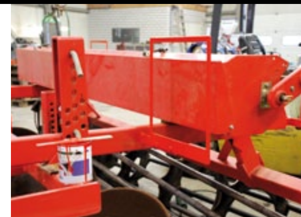
▲ De platen schroef je aan een stevige steun aan de machine. Met primer en lak bescherm je de metalen delen tegen roest.
