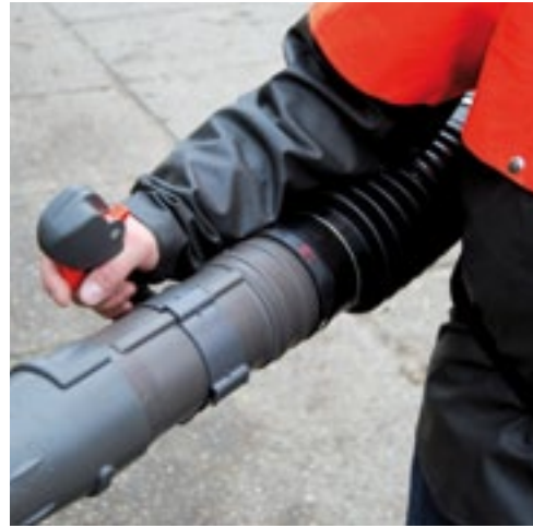
De zijwaartse geplaatste handgreep van Husqvarna vermindert de belasting op de arm.
