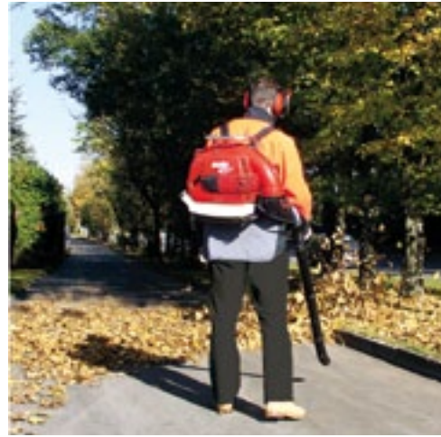
De Solo 471KAT is met een geluidsdruk niveau van 86 dB(A) de stilste rugbladblazer.
