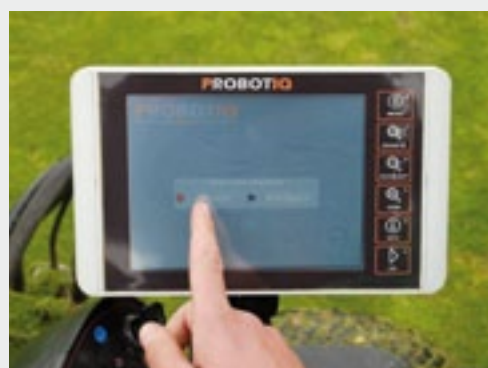
Om een maairoute op te nemen, druk je op 'Teach', dit is de recordknop. Het systeem onthoudt dan exact wat je hebt gedaan.
