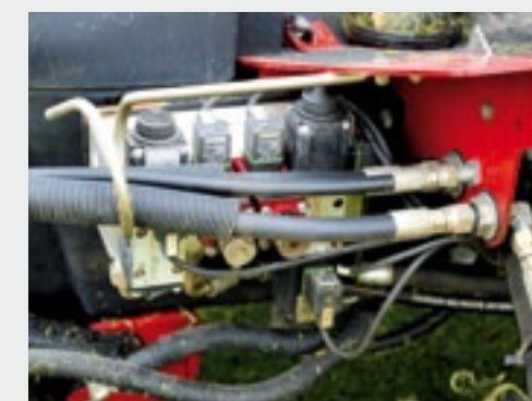
Een elektronisch regelblok stuurt de hydrauliek voor het laten zakken van de kooien en het sturen aan.
