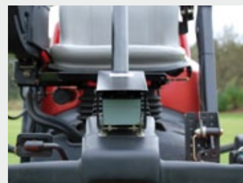
De lasersensor voorop is het oog van de machine. Licht er een obstakel, dan stopt de maaier. De gevoeligheid kun je instellen.
