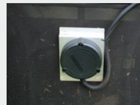
De radar achterop houdt een straal van 3,5 meter achter de machine in de gaten. Bovenop de motorkap zit een noodstop.
