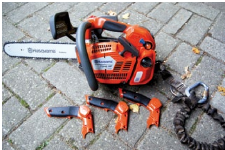
Een handig detail bij de nieuwe T540XP tophendelzaag is de vervangbare handgreep.
