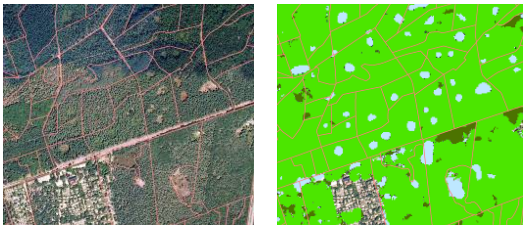
Figuur 21. Op de luchtfoto zijn duidelijk gebieden met lage vegetaties (gekapt/kaal) binnen het bos waarneembaar. Deze gebieden lijken met AHN goed te classificeren te zijn (lichte vlakken).
