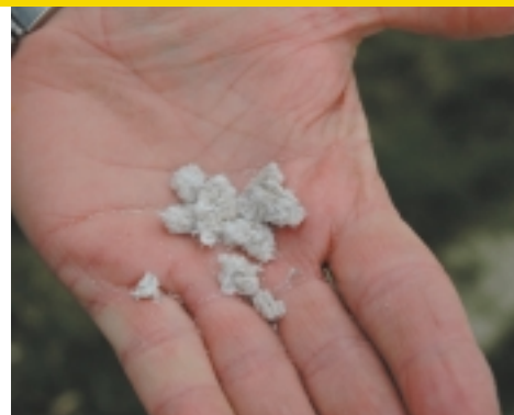
De windgevoelige bunkers worden in de winter met een pap van papiercellulose bespoten die een soort korst achterlaat in de bunkers.
