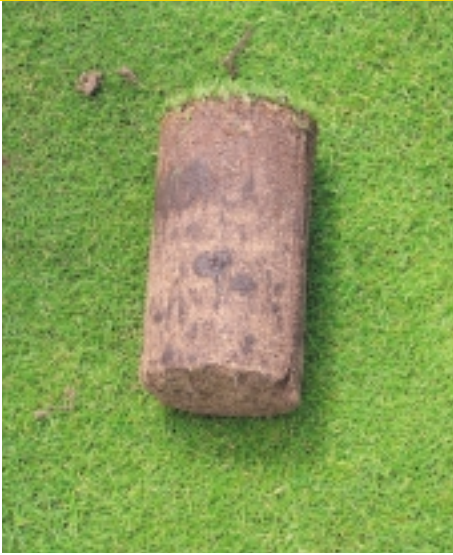
Toplaagprofiel uit het normaal behandelde deel van de green (links) en uit het deel dat met compost werd gedressed.
