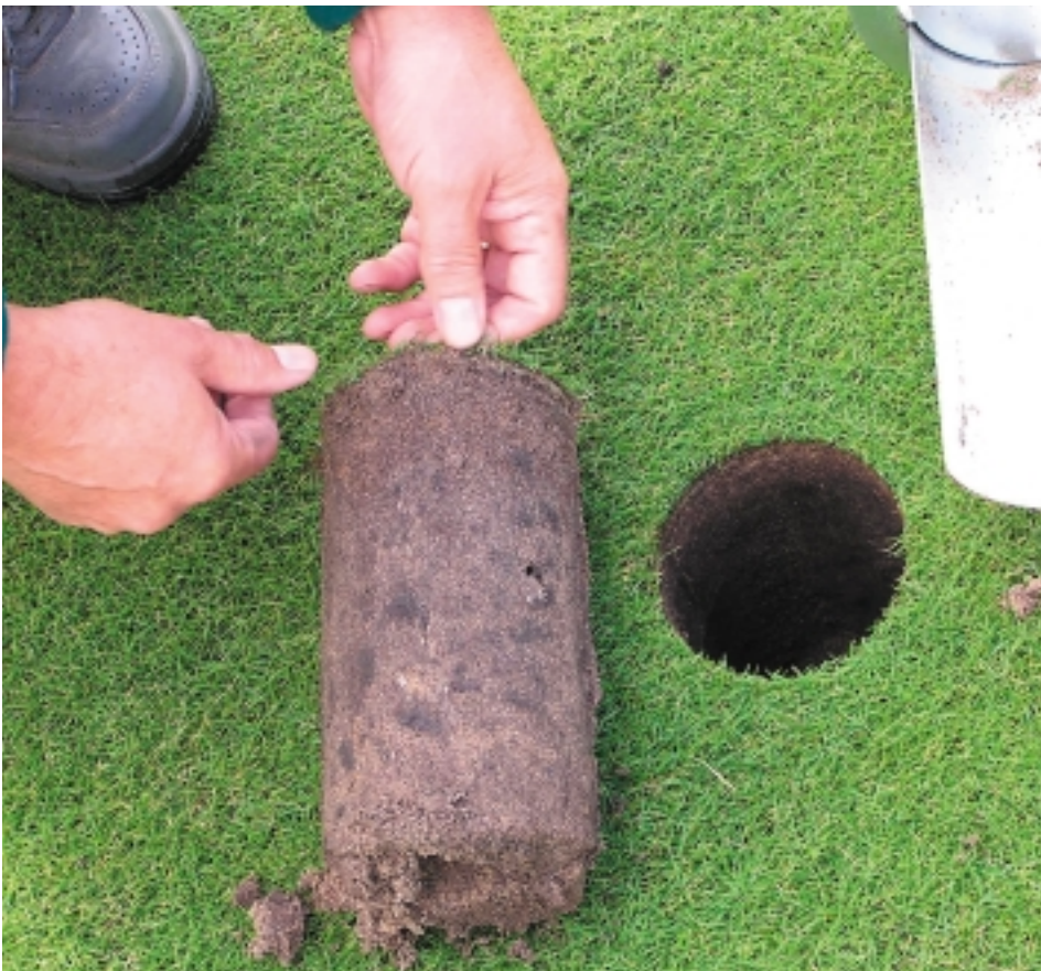
Met de holecutter konden de veranderingen in de viltlaag en profielopbouw goed worden waargenomen.
