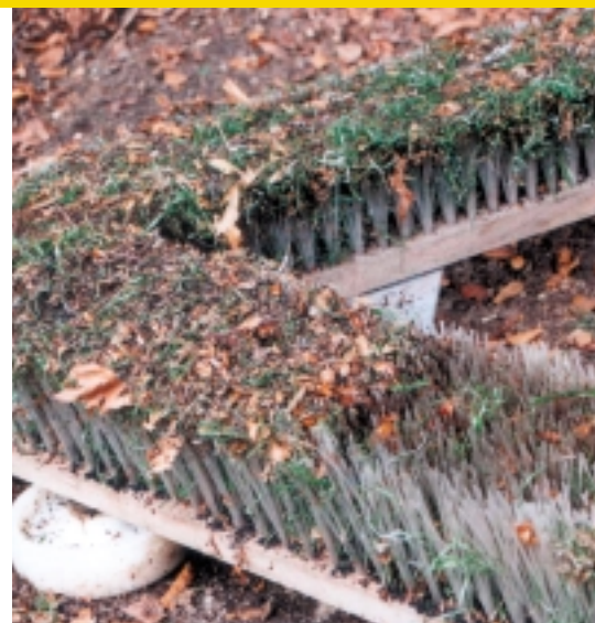
Verskillende typen A-borstels. Een dichte harenbezetting blijkt minder effectief op de meeste rubberingestrooide velden, een harde borstel met minder haren (blauw) werkt beter, vooral in velden met een geringere pooldichtheid.
