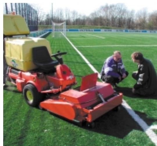
De meeste specialistische reinigingsmachines maken gebruik van roterende borstels om het instrooi-materiaal op te nemen. Door middel van zeven en luchtstromen wordt het gereinigd. Na het terugbrengen in de mat moet het weer worden ingeborsteld.
