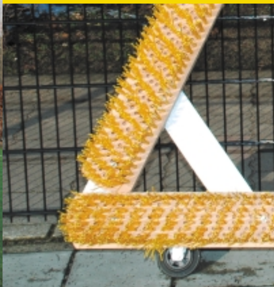
Verskillende typen A-borstels. Een dichte harenbezetting blijkt minder effectief op de meeste rubberingestrooide velden, een harde borstel met minder haren (blauw) werkt beter, vooral in velden met een geringere pooldichtheid.
