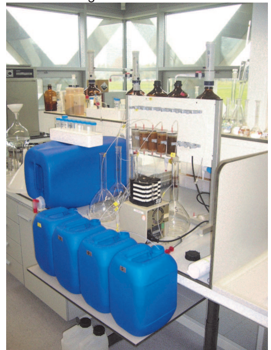
Proefopstelling van kolommen waarin ijzerslib en -zand worden getest.
