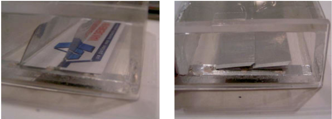
Figuur 1. Het lamellensysteem in open (links) en gesloten stand.
