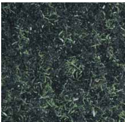
Het weinige rubber dat aanwezig is ligt er boven op, monofilament veld uit 2004
