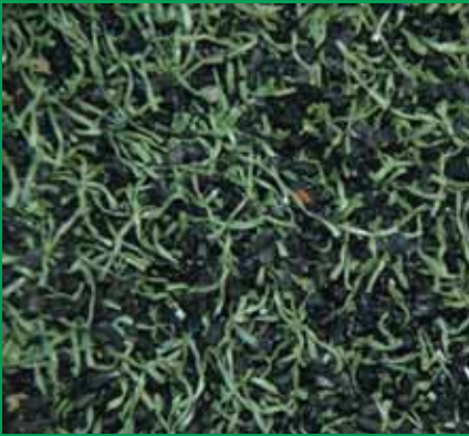
Het weinige rubber dat aanwezig is ligt er boven op, monofilament veld uit 2004
