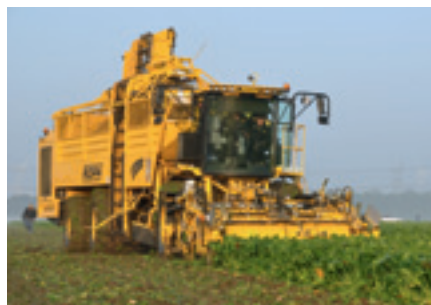
Foto 6. De kleinste en de grootste bunkerrooier op Beet Europe hebben een gelijke maximale wiellast. Bij Ropa (links) is dat gerealiseerd door een betere gewichtsverdeling over alle wielen.
