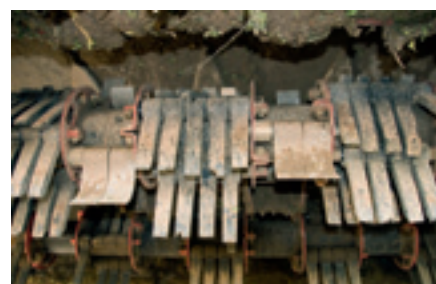
Foto 1. De Grimme FM300-ontbladeraar heeft geen kopmessen en verwijdert de laatste bladresten door intensief poetsen. Dit systeem past ook op een bunkerrooier.
