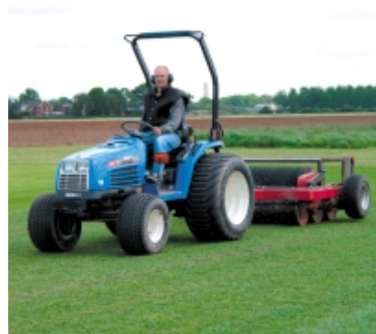
Een speciale betredingsmachine bootst het bespelen en betreden van een grasveld of gazon na.
