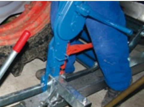
Met de rode spindel aan de rechterkant verstel je het wiel in diagonale richting.
