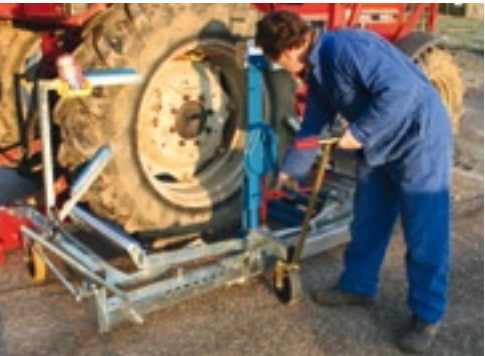
Met de dommekracht kun je het wiel optillen of op hoogte zetten tijdens het afnemen van een wiel.
