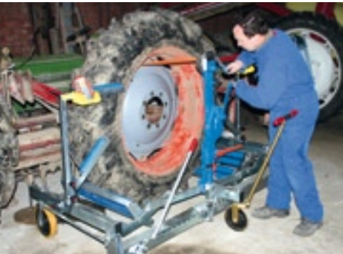
Met de dommekracht kun je het wiel optillen of op hoogte zetten tijdens het afnemen van een wiel.
