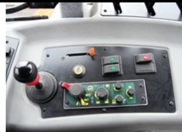
▲ De Terrion 5000-serie is voorzien van een elektronische hefinrichting van Bosch.
