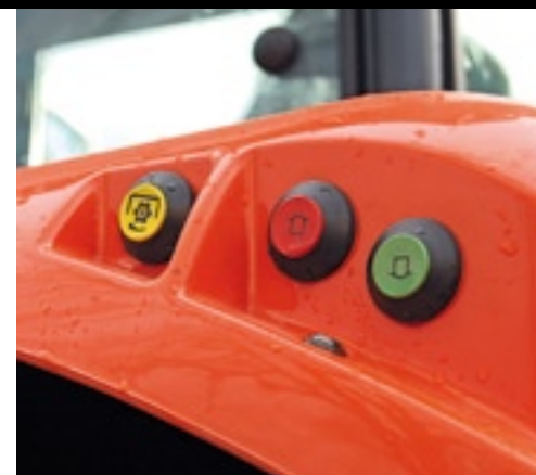
▲ Op beide achterspatborden zitten knoppen voor de hef, links ook een knop voor de aftakas.
