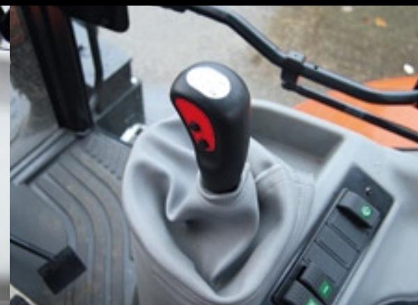
▲ De korte versnellingspook schakelt lekker en is voorzien van twee knoppen voor de powershift.
