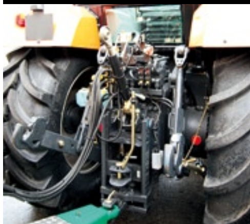
▲ De hefinrichting met imposante cat III/IV koppelingshaken tilt maximaal 10.500 kg.
