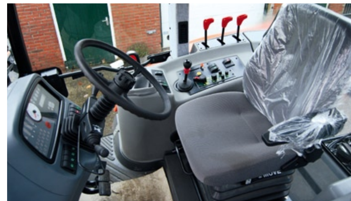
▲ In de ruime cabine is genoeg ruimte voor een rijder en een flinke koelbox. Door de ranke stijlen is het zicht rondom goed. De rechterzijconsole bevat alleen de noodzakelijke knoppen en hendels.
