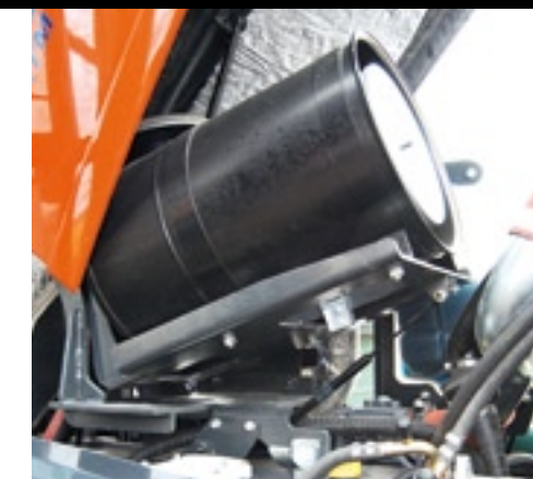
▲ Om het filterelement te verwijderen, klappt het luchtfilter omhoog.
