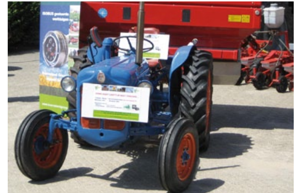
▲ Ook op oudere trekkers, zoals deze Iso Dexta, is zelf een isobusinstallatie te maken, waardoor je gegevens kunt uitwisselen tussen trekker en machine.
