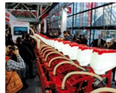
▲ De grote aandachtstrekker van de Eima (letterlijk en figuurlijk) was deze 36-rijige precisiezaaimachine Maximetro van Maschio Gaspardo. De werkbreedte bij een rijenafstand van 75 cm bedraagt 27 meter. Het centrale deel van het frame van de Maximetro staat op een rups-onderstel dat geschikt is voor werksnelheden van 10 tot 12 km/h. Maschio en Gaspardo, die zichzelf presenteren als 'the winning team', claimen met deze zaagigant een capaciteit tot 35 hectare per uur. De fabrikant geeft 'vanaf 400 pk' op als benodigd trekvermogen en als richtprijs 210.000 euro. De eerste Maximetro is verkocht aan een groot landbouwbedrijf in Rusland. LM
