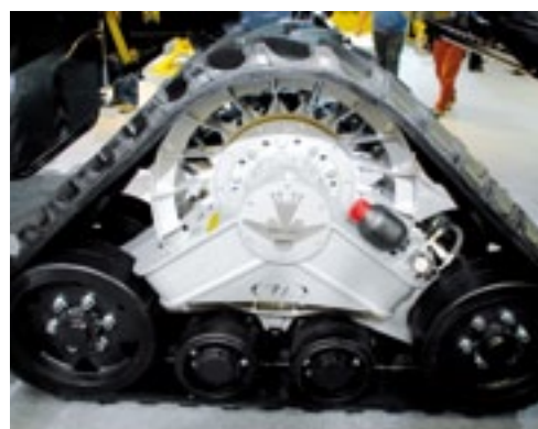
▲ Rupsen zijn populair in Italië. Ze vinden naast trekkers ook steeds vaker toepassing op zelfrijders. Verlaging van bodemdruk staat daarbij centraal, maar ook houvast op hellingen. Deze Amfibios rups van het merk Tidue (uit de plaats Remedello) zit op de achteras van een CR9090 maaidorser van New Holland. Vreemd is dat die achteras niet aangedreven is. De voordelen van een rups gaan zonder die aandrijving goeddeels verloren, omdat de rolweerstand dan groter is dan van een wiel. De fabrikant wilde hier waarschijnlijk vooral laten zien dat een passende maat voor die achteras voorhanden is. Tidue maakt naast 'driehoekrupsen' in allerlei maten ook de gestrekte versie.
