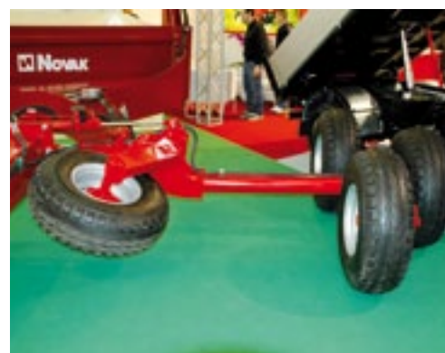
▲ Novak uit de plaats Vercelli is een fabrikant van getrokken kilverbakken en scrapers. De kilverbakken-serie LLS is leverbaar in uitvoeringen van 4, 5 of 6 meter. De bak bestaat bij elk van deze drie breedtes uit een centraal middendeel en opklapbare vleugels. Aan de achterzijde rust de bak (rechts op de foto) op twee sets van elk drie wielen. Tijdens het hydraulisch opklappen van zo'n wielstel draait het transportwiel (dat aan dezelfde arm zit, links) automatisch naar beneden en tilt zo het vaste centrale deel van de bak van de grond. Een bijzondere oplossing om met een minimum aan hydrauliek twee bewegingen te combineren. De werkbreedte van de scrapers is 2,8 of 3,0 meter en ze zijn ook achter elkaar te koppelen.
