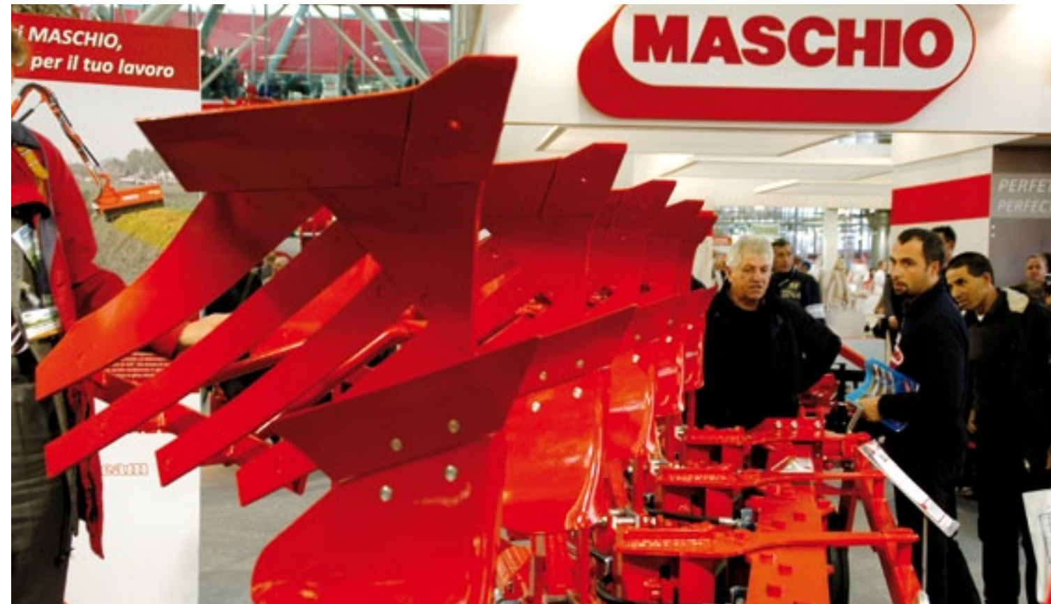
▲ Ploegen zijn nieuw bij Maschio. De afgebeelde Siro VWW (variable working width) lijkt voor de Nederlandse akkerbouw het meest interessant. Hij is er als 120 en als 150. In het eerste geval meet de centrale framebalk 100x150 mm en in het tweede geval 150x150 mm. De '120' is leverbaar van twee tot en met vier scharen en de '150' van drie tot en met zes scharen. Dankzij VWW kan de breedte per schaar variëren van 30 tot 50 cm. Vormec in Steenwijk overweegt de import van deze ploegen.
