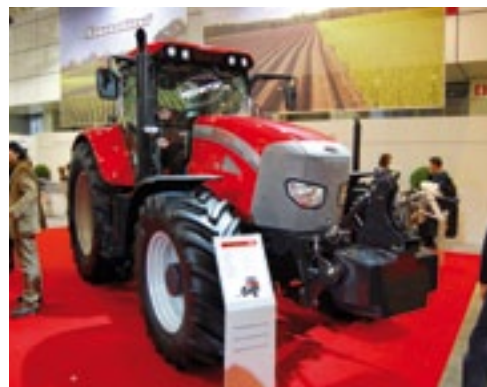
▲ McCormick lanceerde op de Eima de X70 Auto-shift. Dit prototype heeft een motor met de scr-techniek AdBlue (zie grote foto). Het maximumvermogen van de motor met common rail is 171 kW (232 pk); 7 pk meer dan van het huidige vlaggenschip, de TTX230. Het nominaal vermogen is 162 kW (220 pk) en hij voldoet door de AdBlue aan de Stage 3b-eisen. De X70 heeft een 32+24 versnellingsbak die zelfdenkend kan schakelen. De trekker weegt 7.700 kg en de hef tilt maximaal 10.950 kg. De X70 gaat volgens McCormick-moeder Argo in augustus 2011 in productie. Opvallend is het gebruik van een motor van FPT: Fiat Power Train. Fiat is in Italië met New Holland de grote concurrent van de Argo-merken McCormick en Landini.
