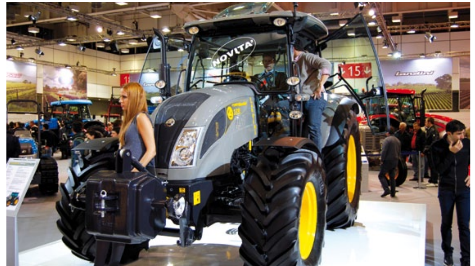
▲ Opvallend bij Landini is de Powermondial 120 Dual Power in ouderwetse kleuren. Deze trekker heeft een elektronisch geregelde Perkins viercilinder met een maximumvermogen van 83 kW (112 pk); met boost is dat maximum (voor aftakas- en transportwerk) 121 pk. Vandaar de naam Dual Power. De transmissie heeft 36+12 versnellingen. De topsnelheid ligt op 50 km/h of in de 'economymodus' op 40 km/h bij 1.900 toeren. De hef kan 4.700 kg tillen. De trekker zelf weegt 4.200 kg.
