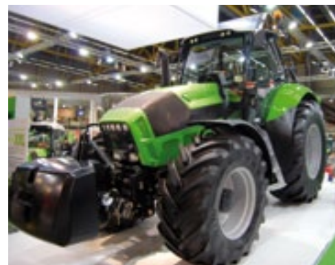
▲ Bij Deutz-Fahr pronkte de TTV 7.260. Dit type wordt het nieuwe vlaggenschip van de cvt-serie van Deutz-Fahr en het is de eerste trekker van dit merk met AdBlue. Onder de motorkap ligt een 6,1 liter Deutz common rail zescilinder die maximaal en inclusief boost 194 kW (263 pk) levert. Het vermogen bij nominaal toerental (2.000) is 179 kW (243 pk). Het maximum koppel bedraagt 1.010 Nm. De cvt heeft vier groepen en is goed voor een top van 50 km/h. De hef tilt 10 ton en de trekker zelf weegt 7.600 kg. Op de cabine zit een zonnepaneel dat voldoende stroom levert om de klimaatcontrole in de cabine op gang te houden als de motor stilstaat. Deutz-Fahr voorziet in de toekomst alle nieuwe trekkers vanaf 130 kW van scr.
