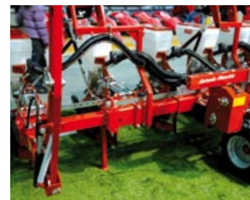
▲ De precisiezaaimachine Flex van Mascar heeft een ingenieus systeem om op een zeer eenvoudige wijze de rijenafstand in stappen van 5 cm te kunnen variëren van 45 tot 75 cm. Het is enkel een kwestie van het omsteken van pennen, waarna de hydrauliek de rest doet. De Flex was er al als zesrijer, maar is nu ook leverbaar met acht elementen. De werkbreedte kan daarmee dus variëren van minimaal 360 cm tot maximaal 600 cm. Afhankelijk van de uitvoering ligt de prijs van deze machine tussen 21.500 en 34.900 euro. Voor een vul-elevator staat een meerprijs van 5.000 euro. Ook een bedienunit voor het elektrisch uitschakelen van elk van de elementen afzonderlijk is een optie.
