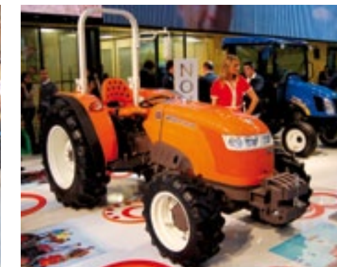
▲ New Holland trok de aandacht met een 'special' in oranje. New Holland maakt deze F480 in de Turkse fabriek van CNH. Designers van Fiat pimpten hem op. Onder de oranje motorkap ligt een viercilinder FPT (Fiat Power Train) met intercooler en 36 kW (48 pk) vermogen. Er zijn acht versnellingen voor- en achteruit via een omkeerhendel. Moderne elektronica heeft deze F480 niet, waardoor hij interessant is voor mensen die een trekker met rechttoe-rechtaan-techniek zoeken. De aftakas is een 540E, de hef tilt maximaal 1.450 kg en de hydrauliek heeft een opbrengst van 61 l/min. New Holland toonde de F480 ook in de normale uitvoering van de T3-serie; hij heet dan T3.50 en de kleur is dan uiteraard blauw.
