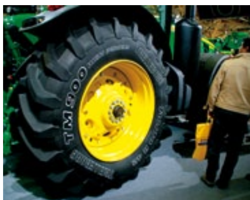
▲ Trekkerbanden moeten steeds groter om het stijgende motorvermogen goed op de grond over te kunnen brengen. De fabrikant loopt daar zowel in de hoogte als in de breedte tegen grenzen aan, vandaar de interesse in drie- en vierassers. De 710/70R42 TM900 van Trelleborg (voorheen van Pirelli) is een van de grotere standaardbanden van dit moment. Dit indrukwekkende rubber met niet mis te verstane opdruk zit hier op de nieuwe John Deere 8.360R. Deze 8R heeft een 9 liter zescilinder als krachtbron en bestrijkt met vijf typen een vermogenstraject (het tweede deel van de type-aanduiding) van nominaal 260 tot 360 pk. Het maximum van de 8.360 zit op 409 pk. De 8R komt volgend voorjaar op de markt.
