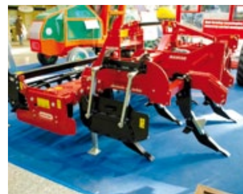
▲ Een fraaie en bijzonder compacte combinatie van een Mascar 5-poots woeler (annex vastetandcultivator) met een Maschio rotorkoepel. De eerste drie letters van Mascar staan overigens ook voor Maschio, maar dan voor Antonio die voor zichzelf is begonnen. De woelpoten kenmerken zich onder andere door het mes dat stoppelresten in de grond doorsnijdt (en zo stroten tegengaat) en door de vleugels die een extra verkruiemeling geven in de toplaag. De rotorkoepel zit vast aan de woeler, maar is dankzij het gebruik van pennen op vijf verschillende hoogtes te bevestigen. De zijplaten passen zich door hun parallelgeleiding automatisch aan aan de werkdiepte van de woeler.
