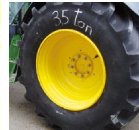
▲ Met een nauwkeurige bandenspanningsmeter en door het gewicht per wiel te meten, is het optimale uit uw band halen. Met deze waarden is in de bandentabel de juiste bandenspanning af te leiden.
