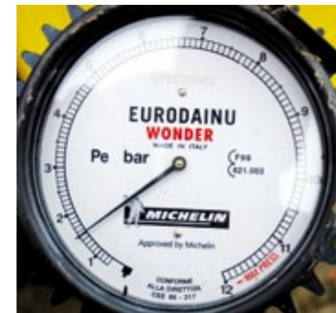
▲ Met een nauwkeurige bandenspanningsmeter en door het gewicht per wiel te meten, is het optimale uit uw band halen. Met deze waarden is in de bandentabel de juiste bandenspanning af te leiden.
