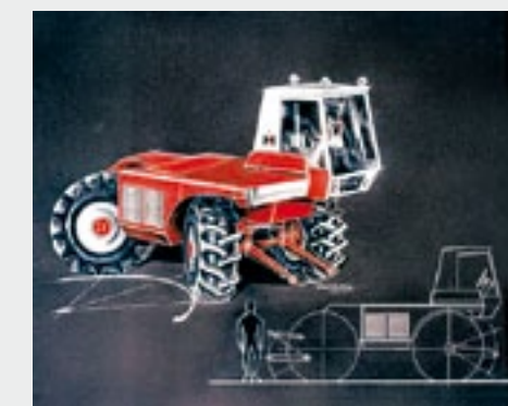
▲ Een cabine voorop de trekker, waardoor er een platform ontstaat met opbouw mogelijkheden, zit al decennialang bij trekker-ingenieurs in het hoofd. Zo bedacht de ontwikkelaar van IH in 1966 al dit tillage-concept. Dit ontwerp had vier even grote wielen die alle konden sturen. Voor en achter zat een even sterke hef.
