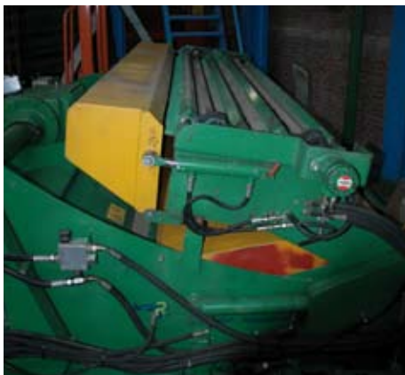
Puin in de bodem noodzaakt vaak het gebruik van een stenenvanger achter de Recyclingdresser.
