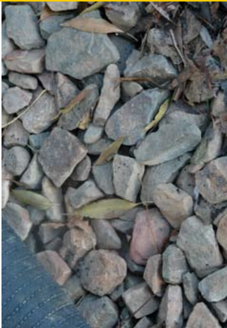
Het gesteente in het Waber-systeem maakt waterretentie onder het kunstgrasveld mogelijk.
