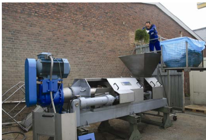
Figuur 8: Mechanisch proces voor het persen van gras (Foto: Wageningen UR Food & Biobased Research).
