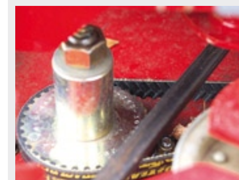
De snaar voor de aandrijving van de twee slagmessen heeft een trekkerbandprofiel.
