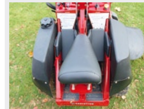
Het zitplatform is geveerd. Je zit ergonomisch op het zadel met je knieën tegen kussens.
