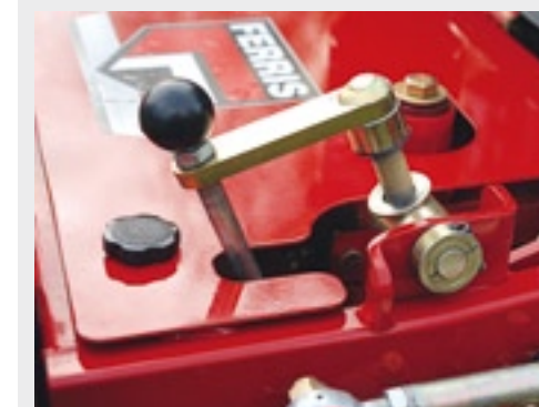
De maaihogte instellen gaat via een draaispindel.
