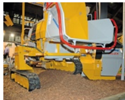
Op moeilijk terrein, zoals taluds, is naast een horizontaalverstelling ook een uitschuifbaar systeem per rups handig, zoals op deze Schliesing.
