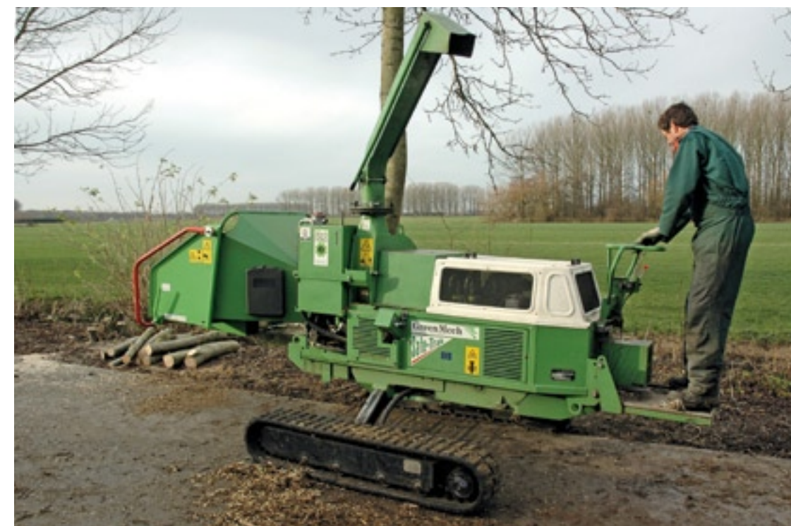
Met uitgeschoven rupsen staat de Greenmech hoog op de poten. Terrein met weinig draagkracht, ruimte en veel stobben en bulten is geen probleem.
