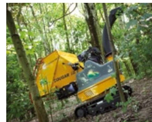
Op rupsen is de versnipperaar een klein zelfrijdend voertuig die erg wendbaar is en waarmee je zo goed als overal kunt komen, zoals met deze Saelen Cougar die 90 cm breed is.
