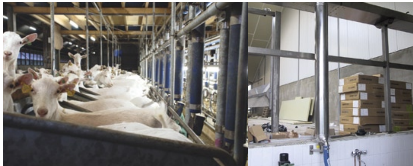
Geitenmelkstallen zijn vaak lang, waardoor bijvoorbeeld reinigingswater over lange afstanden verplaatst moet worden. Dat vraagt om het plaatsen van leidingen op de juiste plek en manier.
