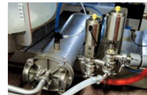
De nieuwe melkpomp van Lely. Lucht duwt de melk naar de tank.
