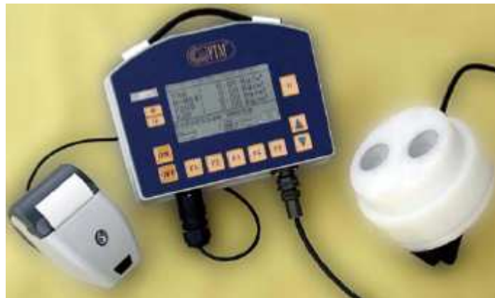
Figuur 10 - De PTM Fertimeter in de vorm van een handsonde
