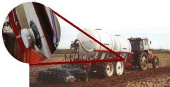
Figuur 11 - De PTM Fertimeter in vaste tankopstelling
