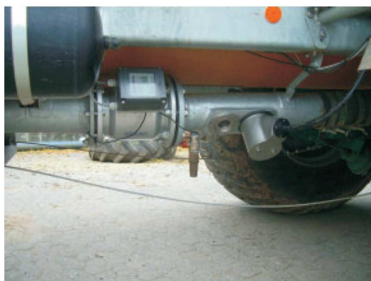
Figuur 14 - Mogelijke locatie van de sensor met links daarvan de doorstroommeter (Bron: Zunhammer, 2009).
