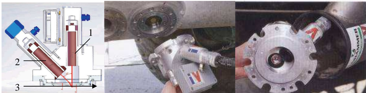
Figuur 13 - Links: Schematische tekening NIR-sensor met lamp(1), sensor(2) en voorbij stromende drijfmest(3). Midden: Venster in buis, waarop sensor gemonteerd is. Rechts: Onderkant, links de halogeen lamp, rechts de sensor (Bron: Böhrnsen, Profi Magazine, 2008).
