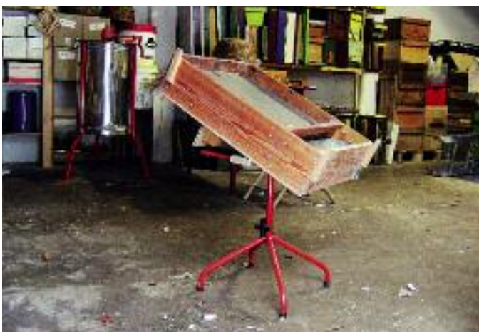
Draaibaar onderstel om zware wassmelter makkelijk met de zon mee te draaien
