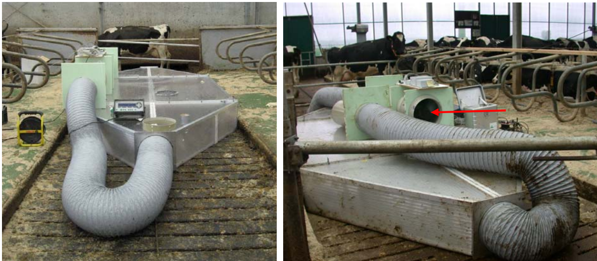
Figuur 2 Meetbox in de praktijk. Bij een statische meting (links) wordt de lucht gerecirculeerd om een luchtsnelheid over het emitterend oppervlak en een goede verdeling van de ammoniakconcentratie te verkrijgen. Bij een dynamische meting (rechts) wordt stallucht aangevoerd (pijl) en over het emitterend oppervlak onder de doos geleid.
