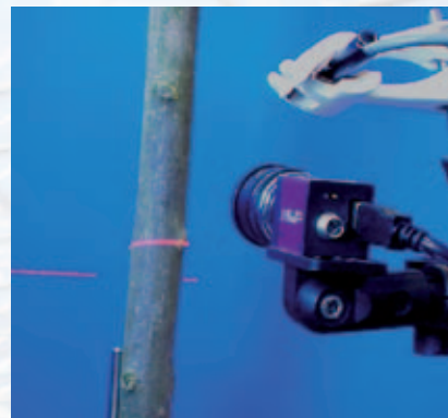
Figuur 3. Boomdiktemeting met Lasertriangulatie
