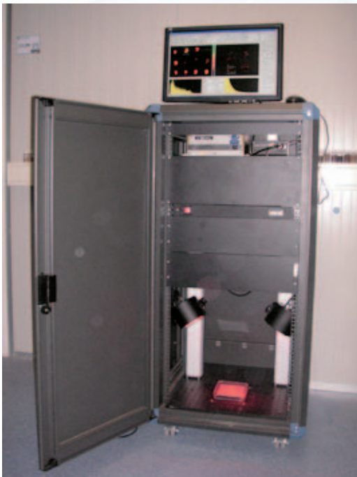
Figuur 1. CF-kiemingscabinet voor het doormeten van zaden op chlorofyl die gevormd is tijdens het kiemingsproces
