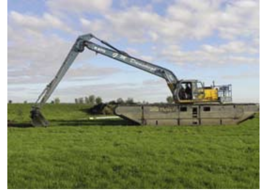
De Big-Float rupskraan die is ingezet om de oeverzone in te versmallen tot 4 meter. Dit type kraan heeft vrij recent zijn intrede gedaan in Nederland.
