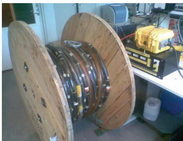
ARRAY MET HYDROFOONS GEWIKKELD OP EEN KLOS
