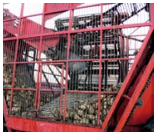
▲ De opvoerband met verdeelvizel zakt bij een lege bunker en komt omhoog naarmate hij vult.
