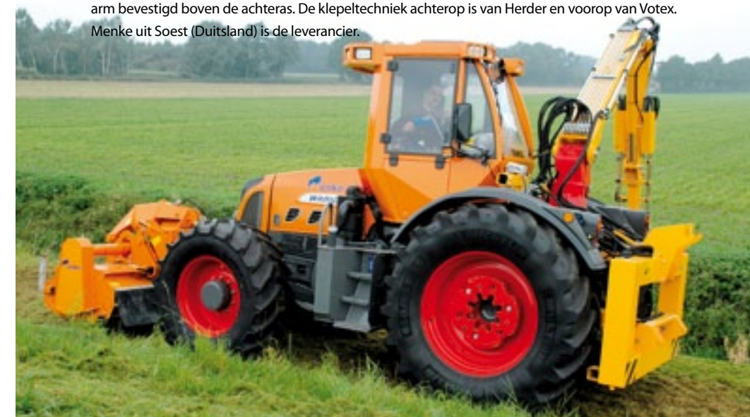
▲ De 'Trac' van Pfnzelt, die ook als Steyr op de markt is, heeft met zijn naar voren geplaatste cabine het grote voordeel dat de opbouw aangrijpt op het stabielste deel van de trekker, namelijk boven de achteras.
