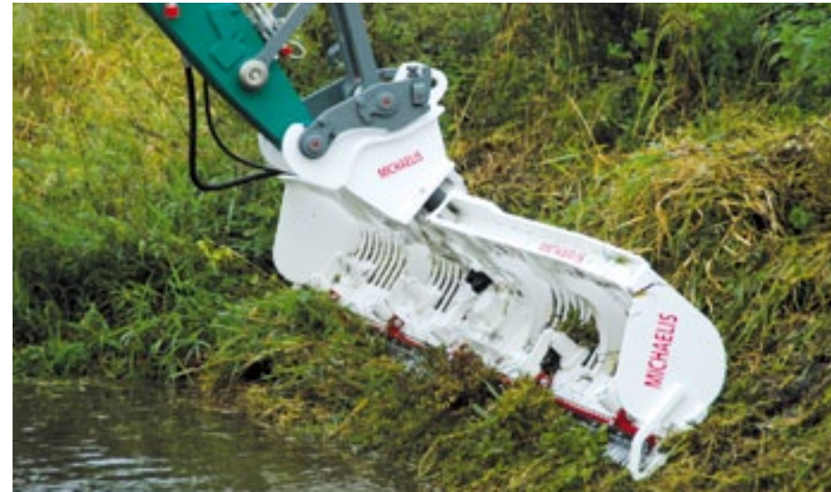
▲ Michaelis uit Grasberg zet in de korf de oliestroom van de hydrauliek om in een heen en weer gaande beweging van het mes. Michaelis gaat in breedte tot 5 meter, de M5000G.
