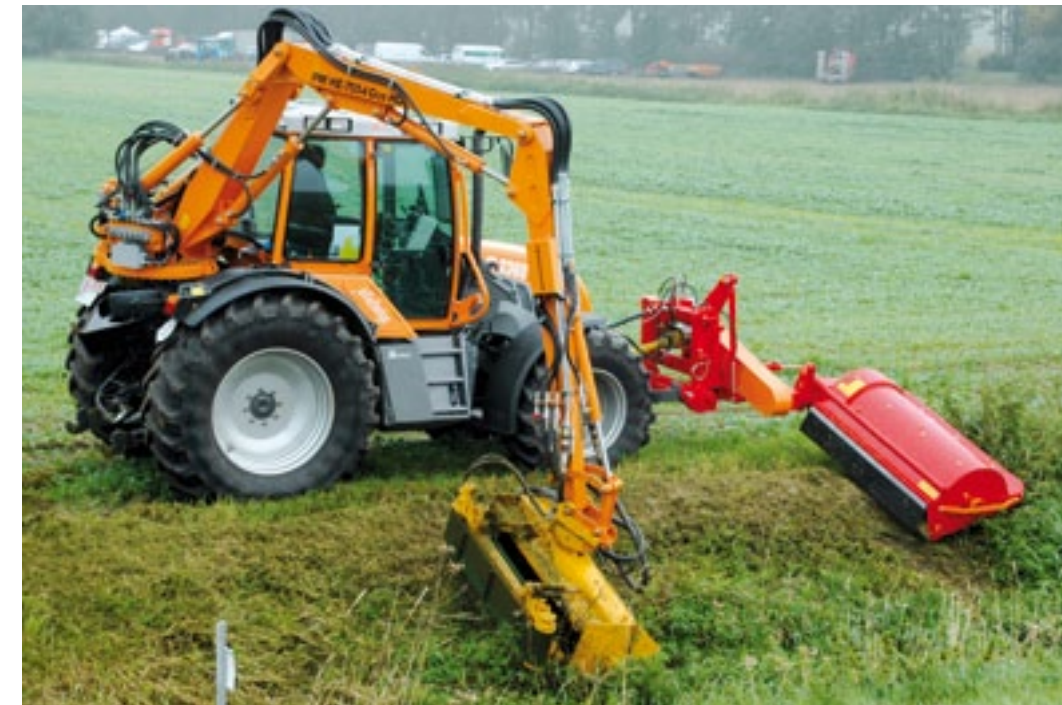
▲ De 'Trac' van Pfnzelt, die ook als Steyr op de markt is, heeft met zijn naar voren geplaatste cabine het grote voordeel dat de opbouw aangrijpt op het stabielste deel van de trekker, namelijk boven de achteras.
