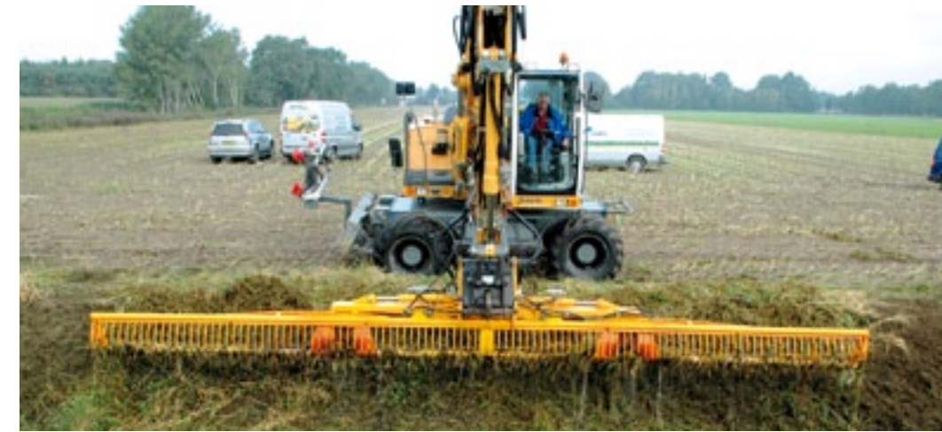
▲ De Herder MXZT 860 werkt 8,6 meter breed en vraagt 80 liter olie per minuut bij 160 bar.
