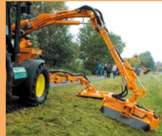
▲ Rebo Landmaschinen uit Visbek-Rechterfeld kort de motorkap van een 30-serie John Deere fors in door onder andere het koelpakket naar de zijkant te verplaatsen. De klepelmaaier van Gilbers past daardoor bij deze 6430 boven de vooras. Er zit een tweede Gilbers in de frontthef.
