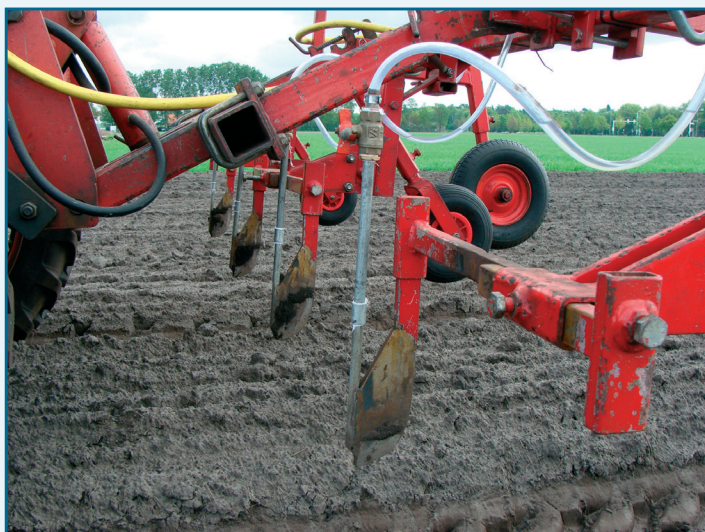
De machine waarmee het fertraat in het onderzoek op Vredepeel als rijenbemesting is toegediend in maïs en prei.
