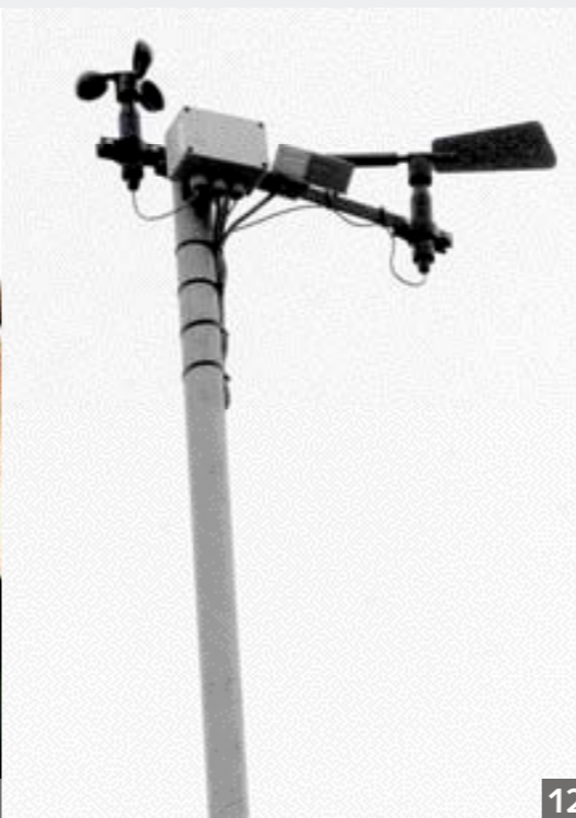
Weerstation bovenop de stal stuurt de opening van het dubbel rolgordijn
