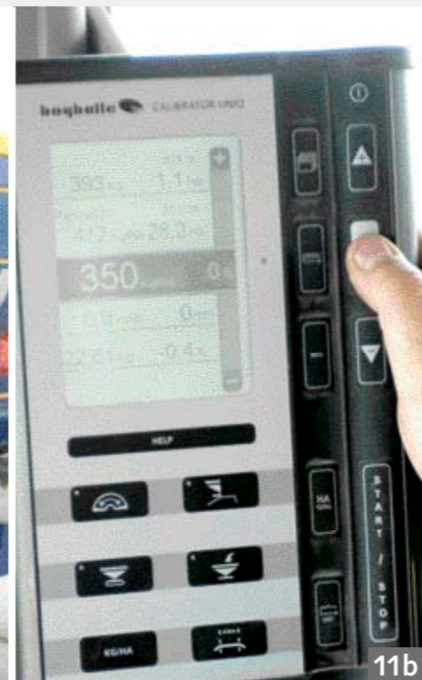
Computergestuurde kunstmeststrooier maakt preciezere bemesting mogelijk Rechts: met een computer op de trekker kan de bemesting nauwkeurig worden ingesteld
