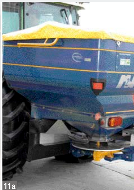
Computergestuurde kunstmeststrooier maakt preciezere bemesting mogelijk Rechts: met een computer op de trekker kan de bemesting nauwkeurig worden ingesteld
