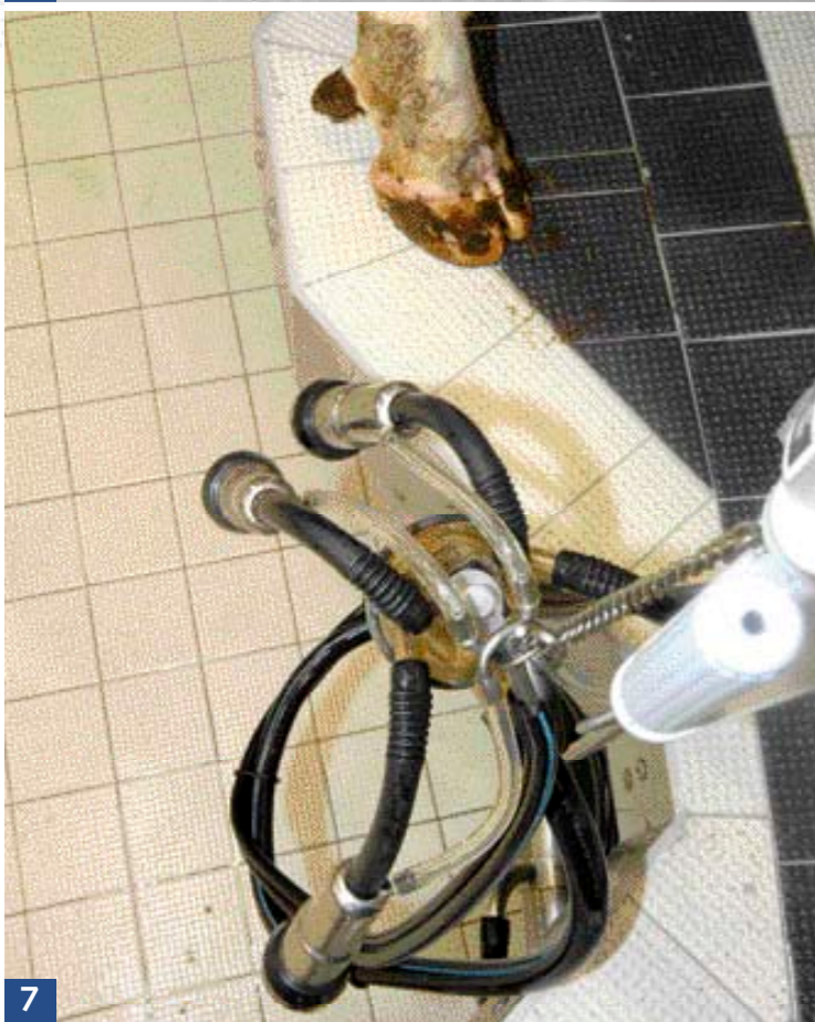
De pulsatieslangen voor de achterspenen zitten aan de binnenkant waardoor ze niet snel geraakt worden door trappende koeien
