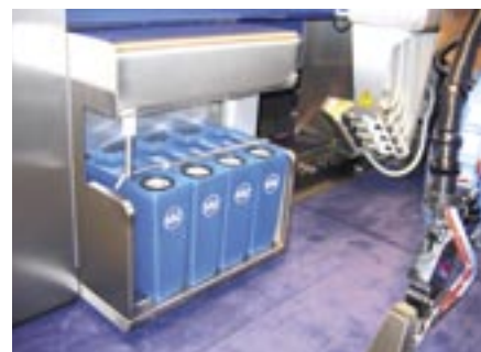
De robotarm pakt de melkleiding en plaatst die boven de separatie-emmers
