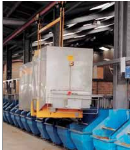
Terwijl de Mix Feeder het voer lost zoekt hij zijn weg over de rail boven het voerhek
