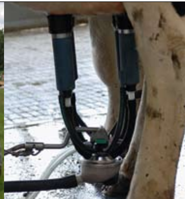
Backflush-systeem in tepelvoering
