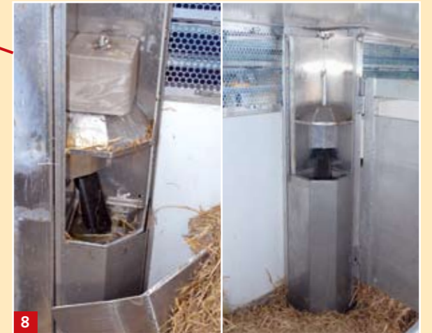
8 De drinkwatervoorziening is instelbaar per leeftijdsgroep, de stalen kolom is verticaal verschuifbaar; kalveren drinken via de kunstspenen, vaarzen uit een drinkbakje
