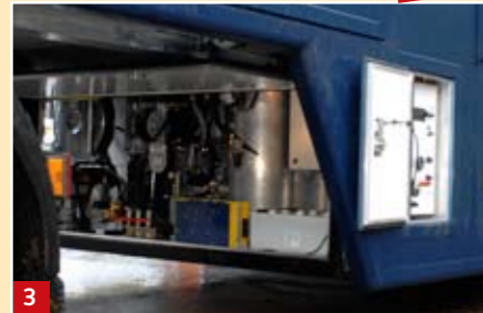
3 De watertank van achthonderd liter (links) levert drinkwater, maar ook spoelwater voor een ingebouwde hogedrukreiniger (rechts)
