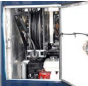
3 De watertank van achthonderd liter (links) levert drinkwater, maar ook spoelwater voor een ingebouwde hogedrukreiniger (rechts)
