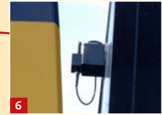
6 Met dit kastje communiceert de vrachtwagen signalen via de satelliet
