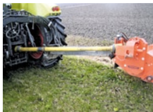
▲ De haakse overbrenging zit op de maaier en drijft met V-snaren de klepelas aan.
