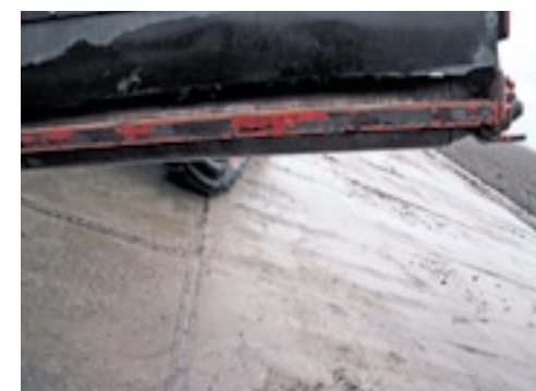
▲ Achteraan de maaier is een rol geplaatst die het bodemoppervlak volgt.
