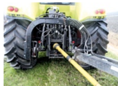
▲ De bok is zwaar uitgevoerd en past in een Cat. Il hefinrichting.
