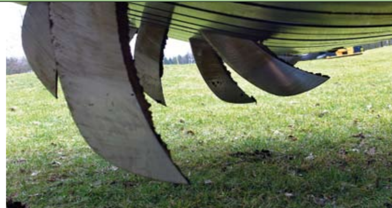
Imants-schudbeluchter doorsnijdt de top-laag van het grasland
