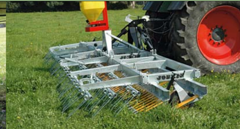
De Scariflex, een combinatie van weidesleep, weidebeluchter en onkruiddeger
