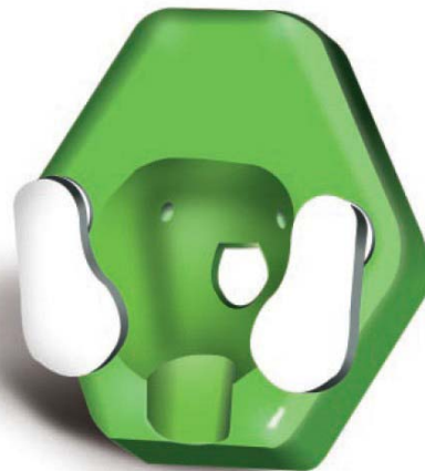
Figuur 10 Cupje van de IR-robot, waarin het kuiken met de kop wordt vastgehouden tijdens de behandeling
