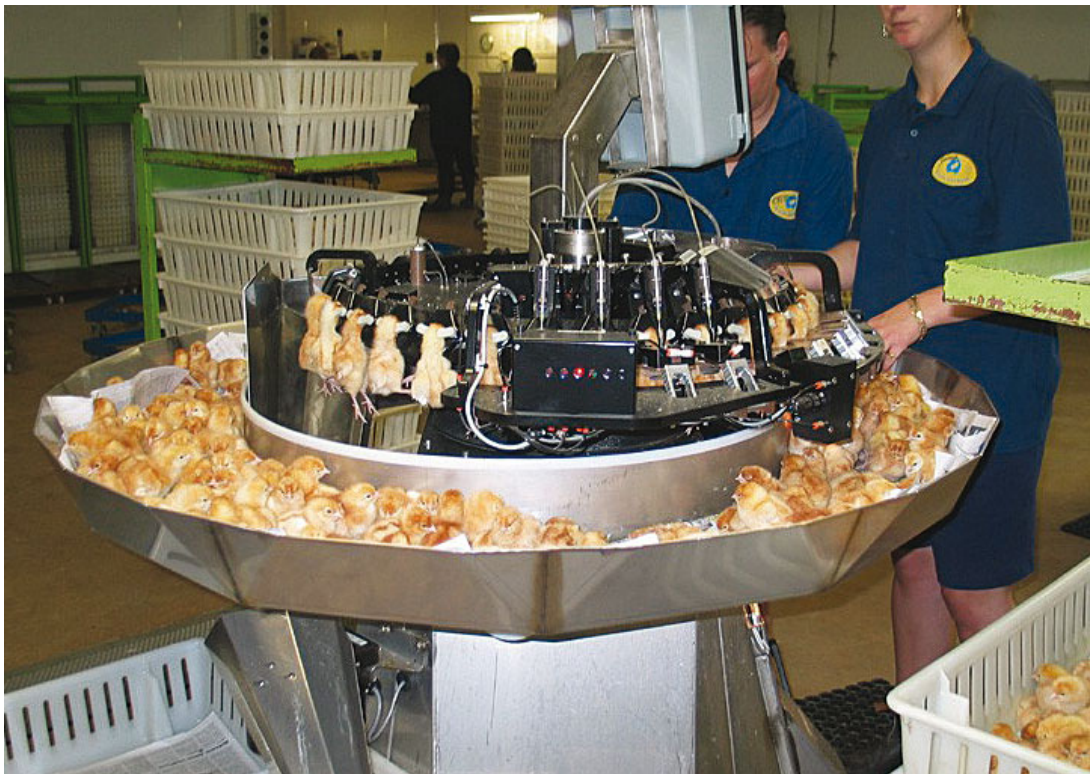
Figuur 9 Infrarood snavelbehandelingsrobot (Foto SARDI, AUS)
