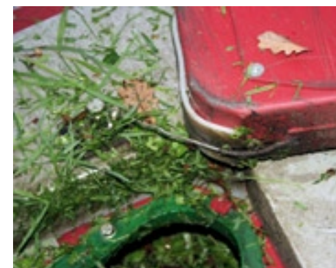
Het maaidek van De Jong heeft een kabeltje dat het terugzwaaien van het maaidek bespoedigt.
