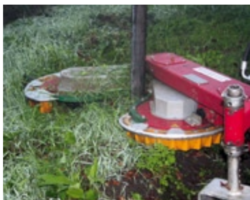
Het maaidek vangt met de V-vorm de paal op en draait helemaal om de paal. Door verder te rijden draait de machine 180 graden. De paal gaat dan uit de maaier en het maaidek klapt weer terug in de beginpositie.
