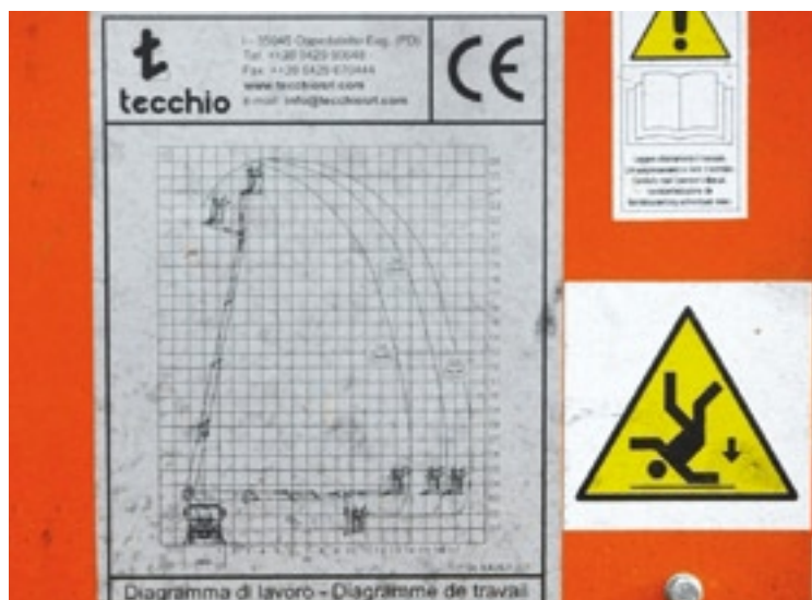
Het werkdiagram geeft aan wat de grenzen zijn van het toelaatbare gewicht afhankelijk van hoogte en reikwijdte. Komt de gondel buiten deze grenzen dan volgt een waarschuwing met lampen. Ook kan elektronica het bereik begrenzen als dat wordt overschreden.
