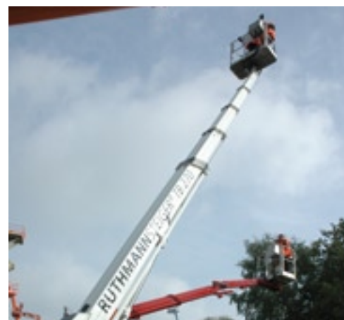
Ruthmann heeft met de TB270 een 27 meter lange telescopische arm op een auto voor het B-rijbewijs. Op de achtergrond de kleinere TBR200. Als telescoop met jib typisch een model voor de groenvoorziening.
