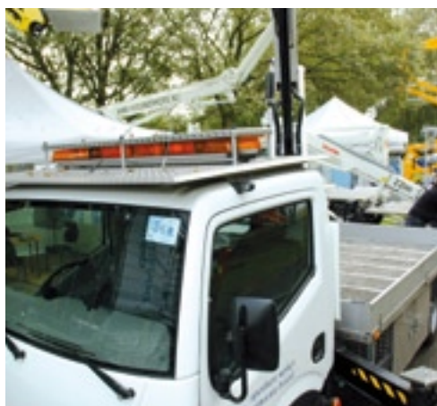
Deze Tecchio van de gemeente Boxtel is uitgevoerd met extra bescherming van het cabinedak en de kwetsbare delen op de steunpoot.
