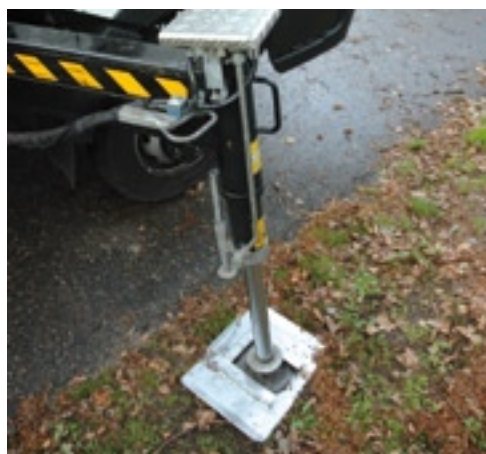
Deze Tecchio van de gemeente Boxtel is uitgevoerd met extra bescherming van het cabinedak en de kwetsbare delen op de steunpoot.
