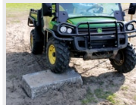
Alle vier wielen worden aangedreven. Een obstakel voor een wiel is dan ook geen probleem.
