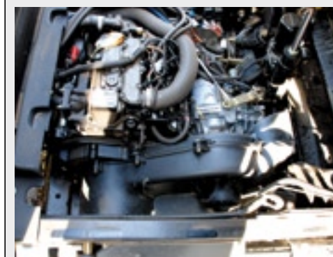
De cvt-transmissie is nu volledig afgeschermd tegen vuil.
