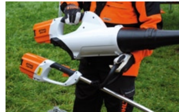
De handgrepen van de accuhandbladblazer en de accubosmaaier zijn precies hetzelfde.
