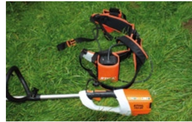
In de accugordel kunnen drie accu's: twee als reserve en een als aandrijfbron.
