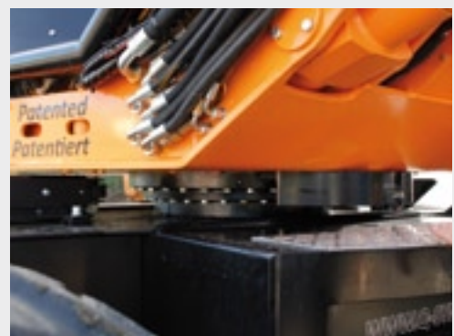
In shovelstand kun je de bovenbouw blokkeren. Dit gebeurt via een mechanisch hydraulische blokkering van de draaikrans.
