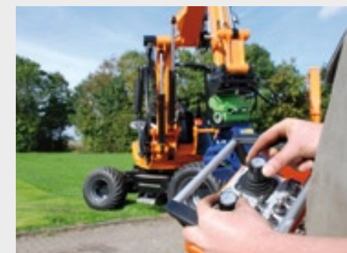
De kraan is met een afstandsbediening te besturen. Met een versnipperaar in de hef kun je dan tegelijk hout hierin invoeren.
