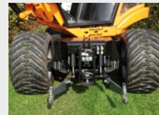
De hef tilt 2 ton. Er zijn een 540/1.000 aftakas en twee extra hydraulische functies. De achterwielen zijn groter dan de voorwielen.
