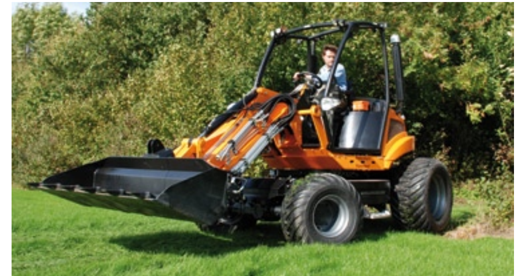
De Q Synchro omgetoverd tot shovel. De driedelige giek is opgevouwen tot een massieve laadschop-arm. Hiermee is 1.700 kg te tillen en tot 2,80 meter. De uitbreekkracht is ongeveer 2 ton.
